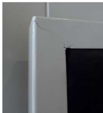
La tecnologia Salvagnini ha permesso ad Ausonia di ottimizzare i propri prodotti. A sinistra dettaglio di sportello piegato e saldato, a destra realizzato senza saldature con ausilio della pannellatrice.
