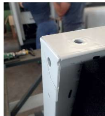
La tecnologia Salvagnini ha permesso ad Ausonia di ottimizzare i propri prodotti. A sinistra dettaglio di sportello piegato e saldato, a destra realizzato senza saldature con ausilio della pannellatrice.
